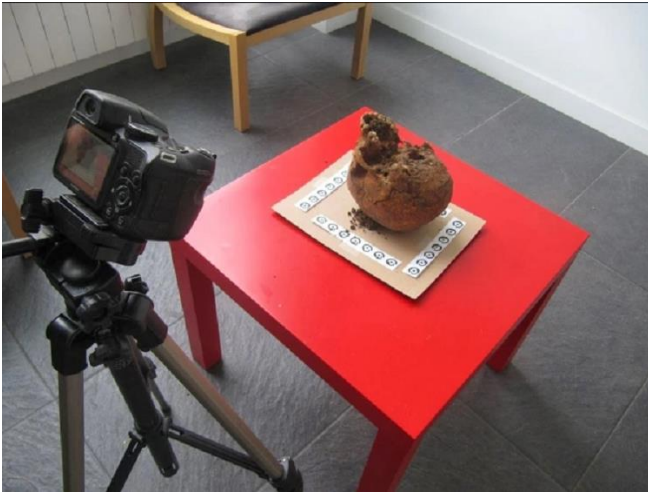
Fotografía del proceso de documentación fotogramétrica de un cráneo.
