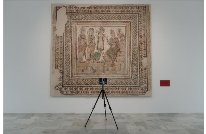
Escáner láser 3d Faro delante del mosaico de París en la Colección Museográfica de Casariche. Autora: Sol Martín Carretero.
